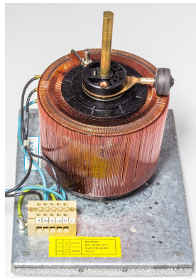
Fig. 3.24: Exemplary autotransformer (source: Wikimedia Commons , R. Spekking, CC BY-SA 4.0)
